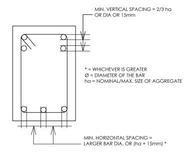
TYPICAL DETAILS FOR MINIMUM CLEARANCE BETWEEN INDIVIDUAL BARS
