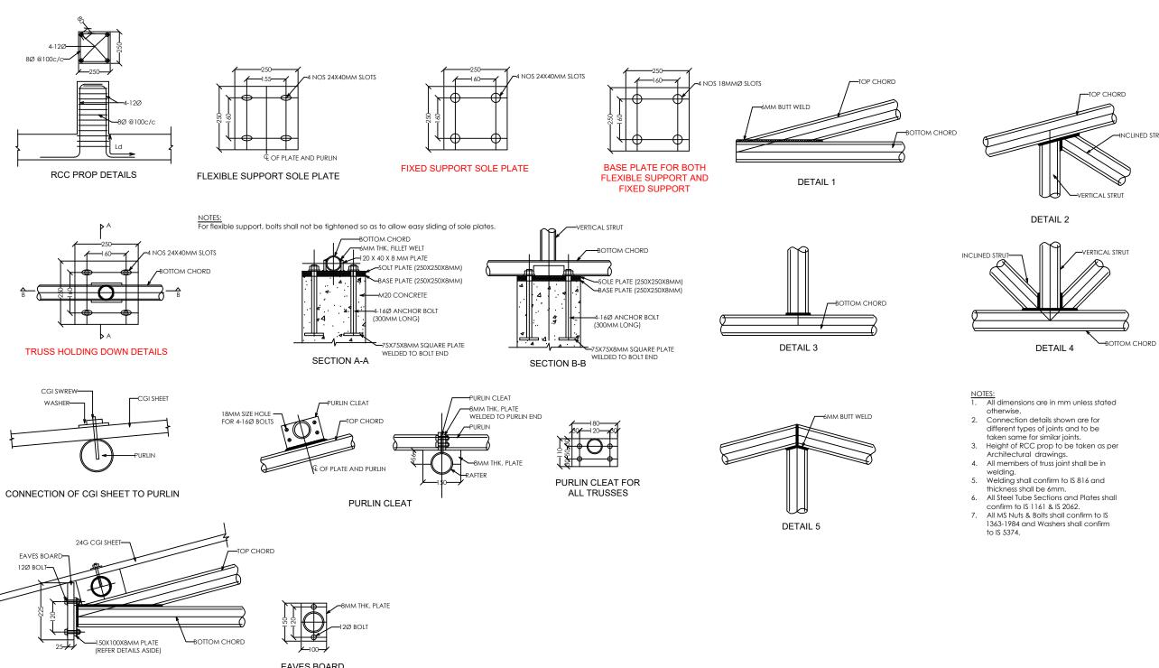
CONNECTION OF EAVES BOARD TO STEEL TRUSS
